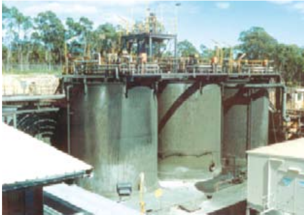
Photo 2 : Biolixiviation en réacteur: Traitement de l'or réfractaire, 70 t/jour (Concentré pyrite, arsenopyrite) Mine in Tasmania, (Australia)
