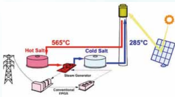
Schéma d'une centrale munie d'un système de stockage de l'énergie
