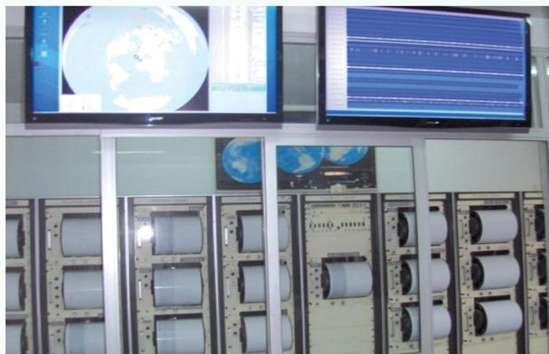
Centrale d'acquisition et de traitements des données sismiques en temps réel pour les besoins de l'alerte sismique 24/24.
