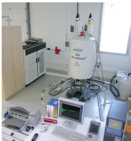
**Figure 16 :** Spectromètre de Rmn à aimant supraconducteur
