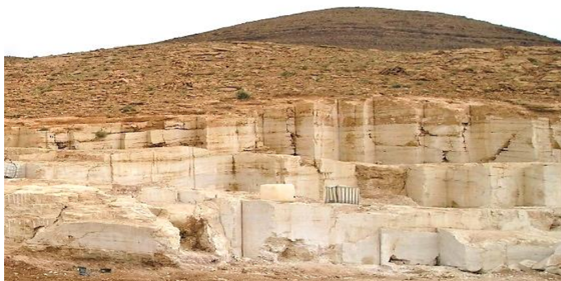
Figure 60 : Carrières de travertin beige vacuolaire, en extraction par gradins.
