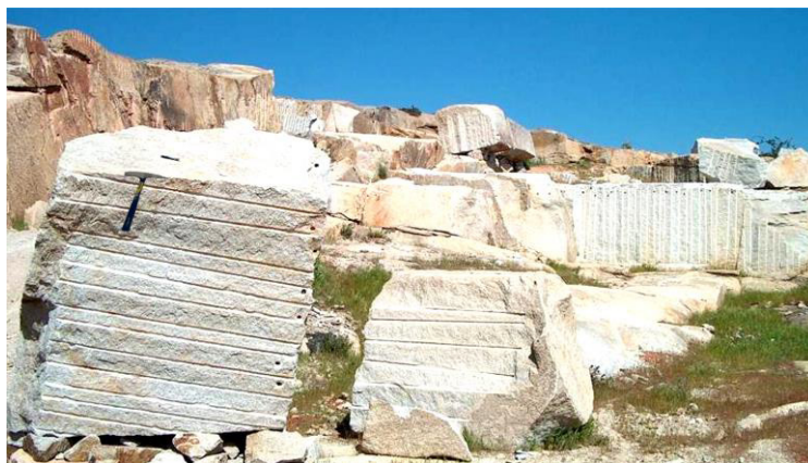
Figure 71 : Carrière d'exploitation du granite gris d'Oulmès, extrait à la masse et à la burette.
