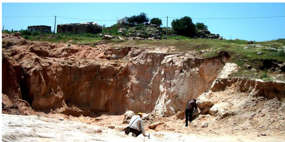
Figure 36 : Carrière d'exploitation du granite kaolinisé en bordure du pluton d'Oulmès.
