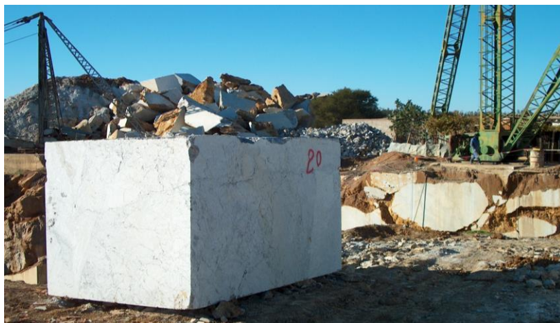
A- Bloc brut de marbre gris de Tiflet extrait à la haveuse
