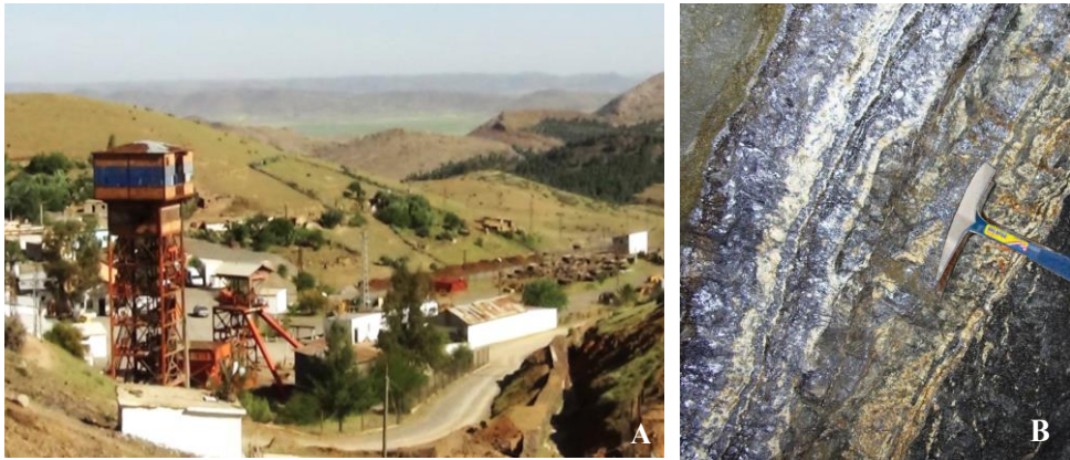
Figure 32 : A- Vue d'ensemble de l'environnement de la mine de Pb-Zn de Tighza, au niveau du filon Signal. B- Détail du filon Signal, riche en galène (PbS) et sphalérite (ZnS), liées par une matrice carbonatée.
